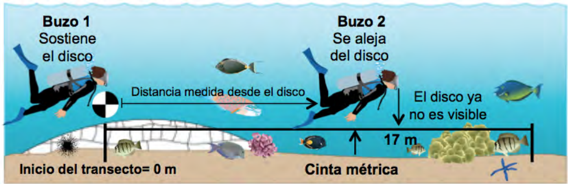
Figura 13: Medición recomendada con disco Secchi para monitorear la calidad de agua en arrecife
